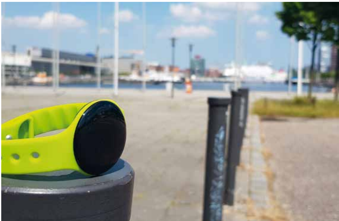
Kompatibel mit der Corona-Warn-App: Das in Kiel entwickelte Warnarmband nutzt Bluetooth für den Datenaustausch.
